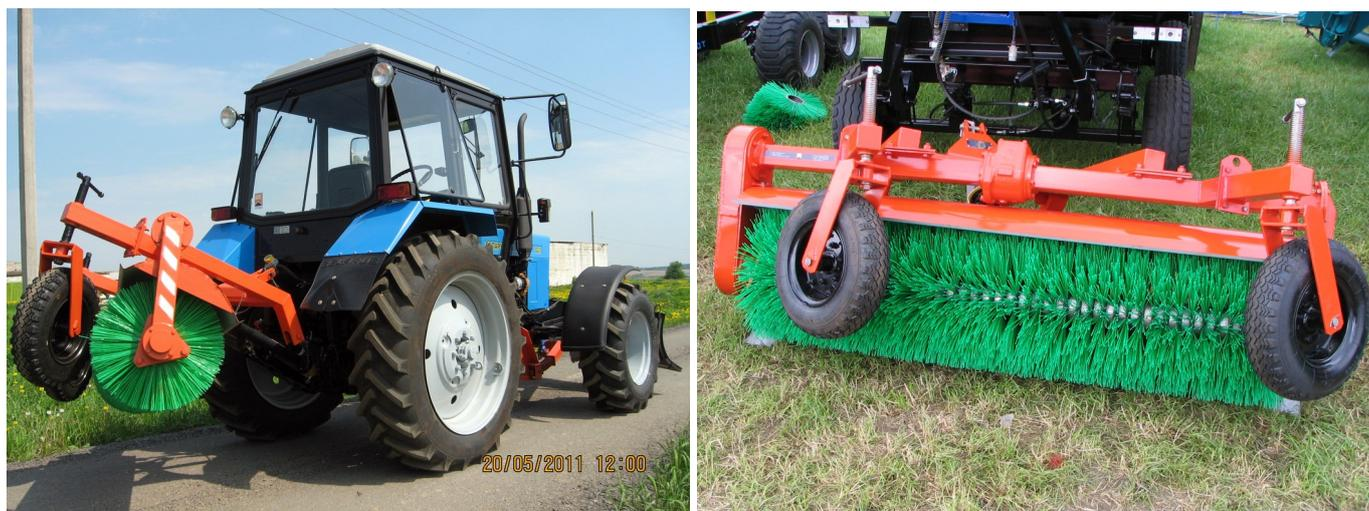
Оборудование навесного типа предназначено для механизированной уборки проезжей части улиц, дорог, тротуаров, площадей и производственных территорий от песка, мусора, свежеснежавшего снега.
